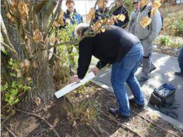
*Einsatzes eines Resistographen zur Überprüfung der Verkehrssicherheit*
