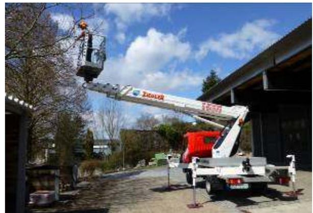
*Einsatz einer Systemlift LKW-Arbeitsbühne unter beengten Verhältnissen*
