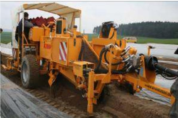
*Spargelvollernter Kirpy im Einsatz. Die gesamte Erde des Dammes mit den abgeschnittenen Spargelstangen gelangt auf der Siebkette nach oben. Vier Arbeitskräfte packen die Stangen in die Erntekisten. Ein komplett neuer Damm wird geformt.*
